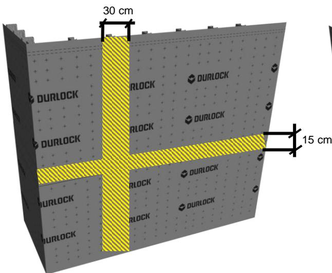
**3** Para unir los rollos en sentido horizontal debe solaparlos 15 cm en esa dirección y 30 cm en forma vertical. El solape debiera ser continuo sin interrupciones (sin necesidad de encintado).
