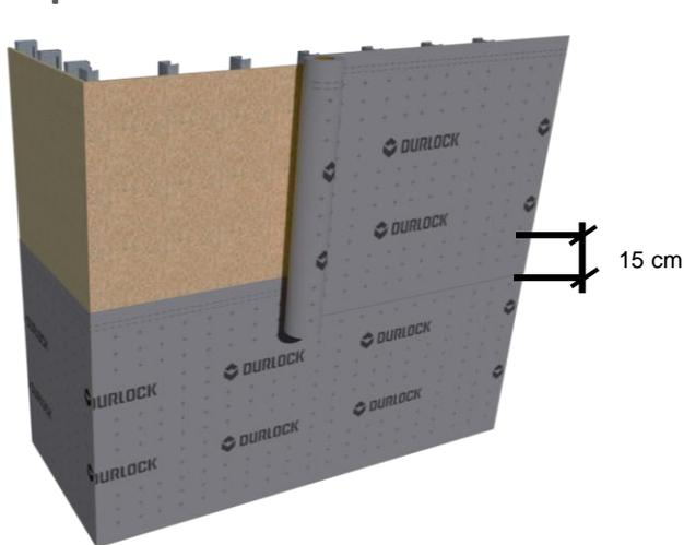
**1** Sobre la placa de rigidización, coloque en sentido horizontal el rollo de barrera Hidrofuga, comenzando de abajo hacia arriba. El primer rollo se coloca fijando con grampas industriales. Generar un solape horizontal (sobre posición) entre la inferior y la superior de 15 cm como mínimo.
